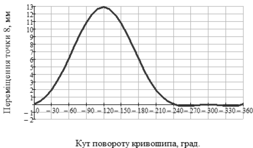
Рис. 3. Графік переміщення робочої точки механізму III класу
