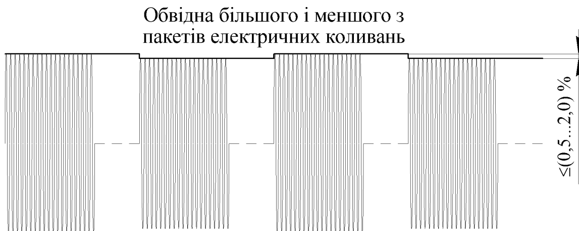
Рисунок 3. Обвідна більшого й меншого з пакетів електричних коливань після амплітудного детектора 12
